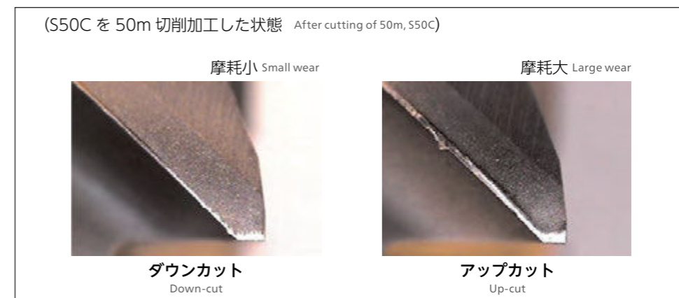
切削方向の違いによる工具摩耗量比較写真 Difference of edge wear by cutting directions
